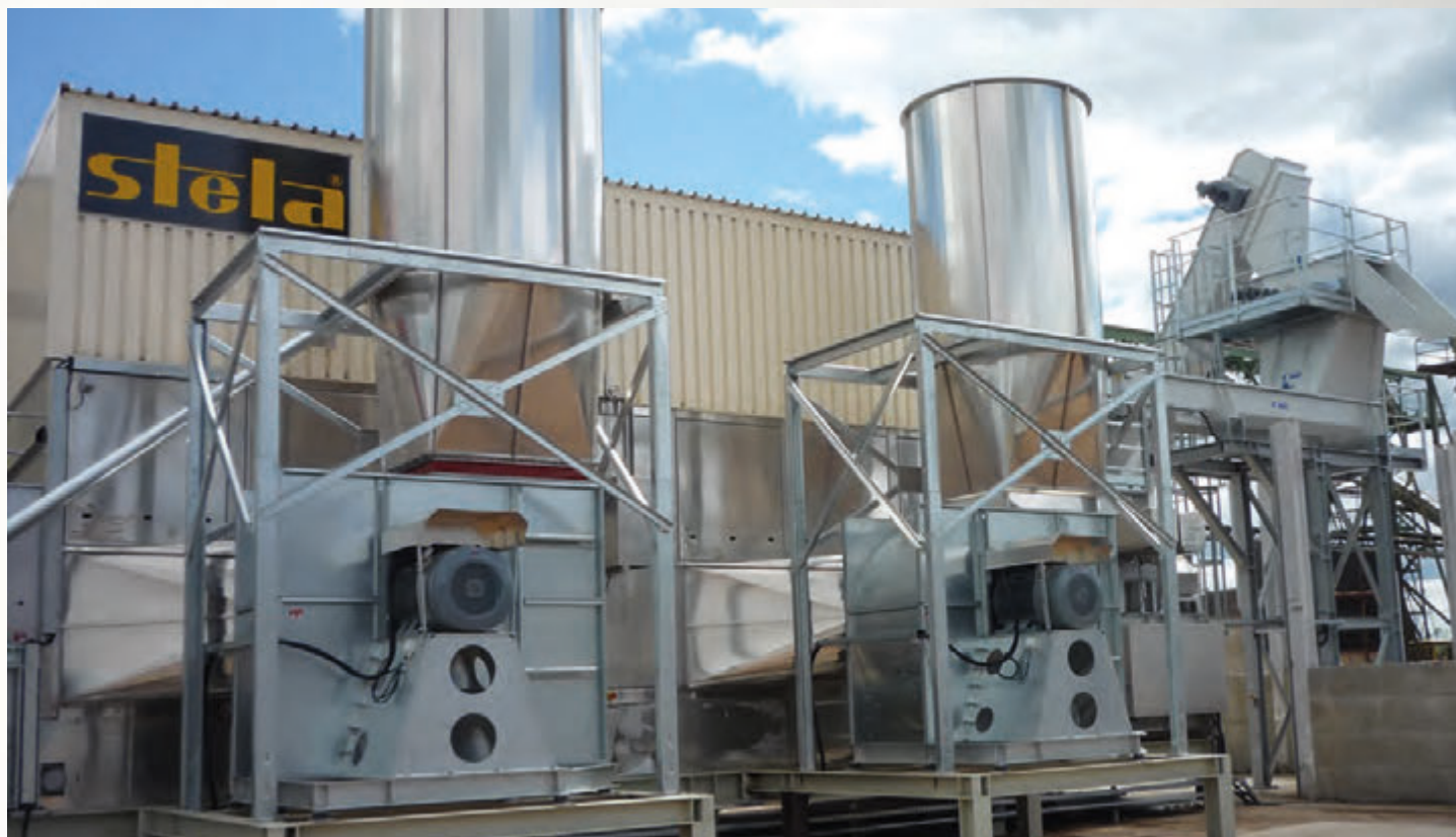
项目地：Hasslachlerles GmbH, 俄罗斯 | 型号：BT 1/6200-12 | 安装年份：2014 干燥物料：木屑 | 出料能力：约3.5吨/小时 | 降水区间：55% - 10%湿度
