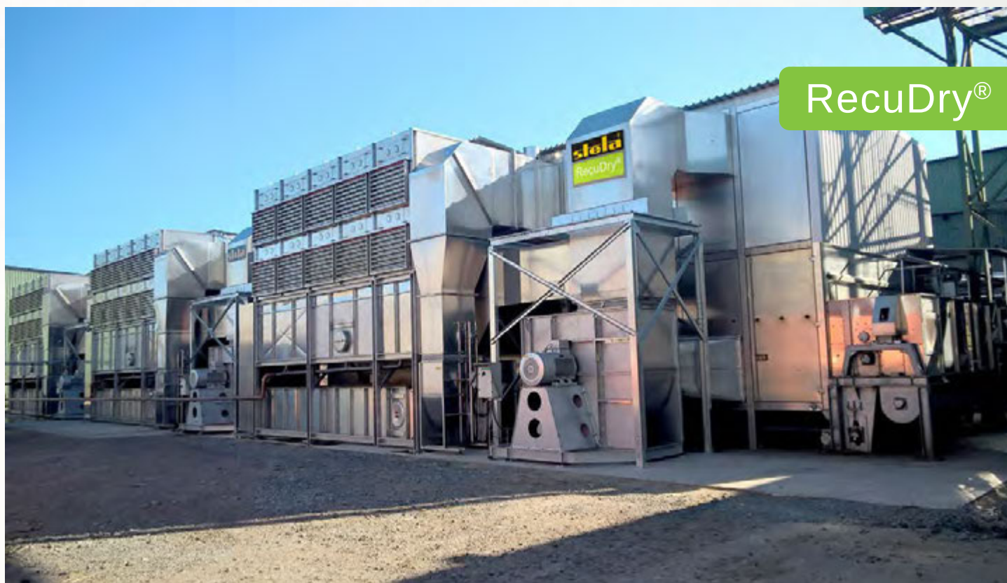
项目地：Stora Enso Timber AB, 瑞典 | 型号：BTU RecuDry 1/6200-45 | 安装年份：2018 干燥物料：木屑 | 出料能力：约10.0吨/小时 | 降水区间：52% - 10%湿度
