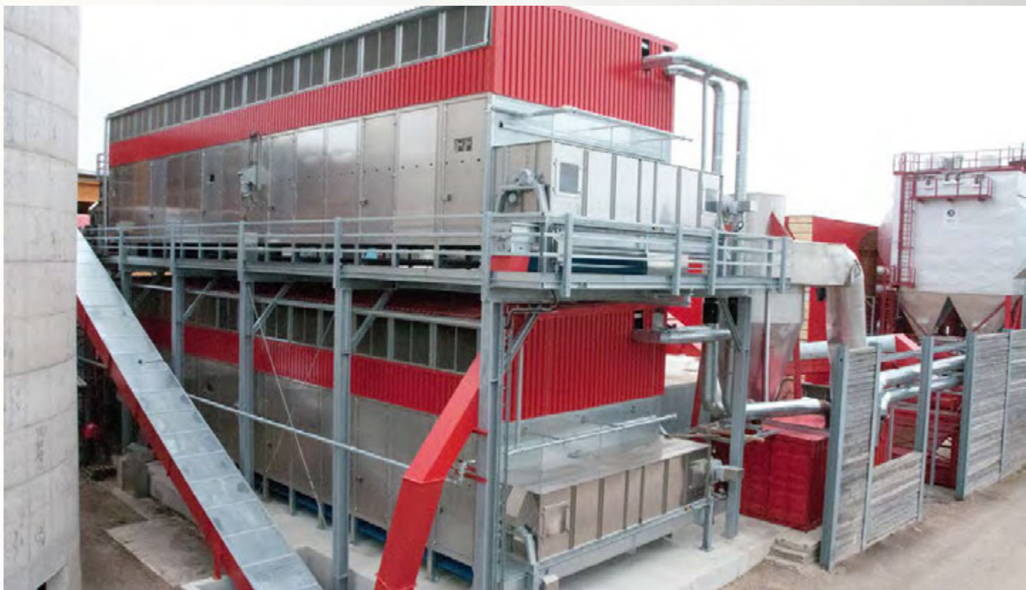
项目地：German Pellets, 德国 | 型号：2x BT 1/6200-22.5 | 安装年份：2010 干燥物料：木屑 | 出料能力：约14.0吨/小时 | 降水区间：50% - 10%湿度
