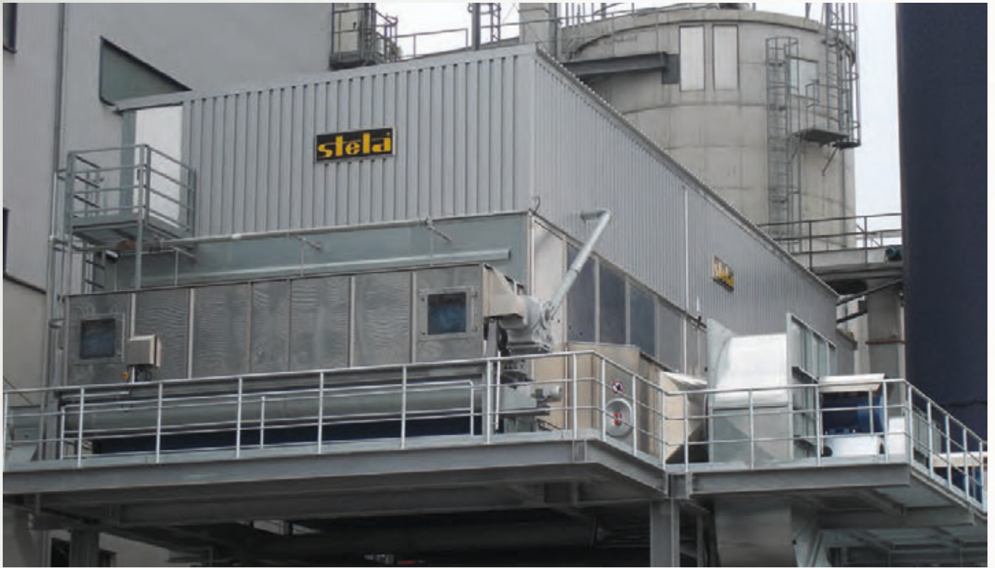
项目地： Compactec (Intrinerger) Germany, 德国 | 型号： BT 1/6200-19.5 | 安装年份： 2009 干燥物料： 木屑 | 出料能力： 约7.5吨/小时 | 降水区间： 50% - 10%湿度
