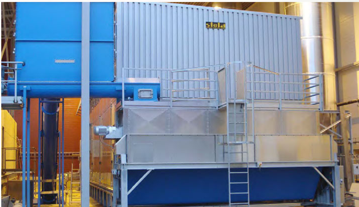
项目地：Rindi Älvdalen AB, 瑞典 | 型号：BT 1/6200-19.5 | 安装年份：2009 干燥物料：木屑 | 出料能力：约12.2吨/小时 | 降水区间：50% - 26%湿度
