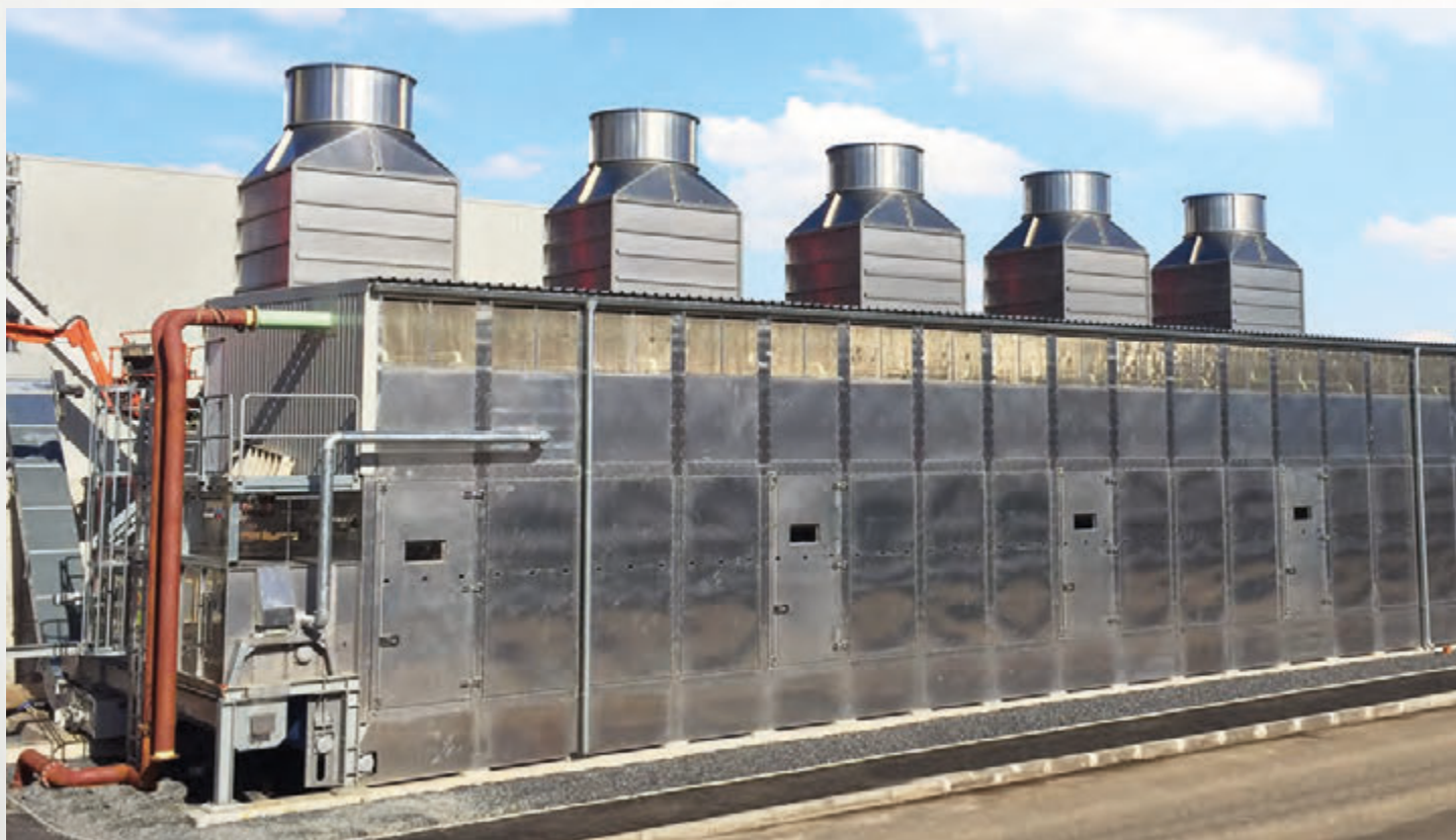
项目地：Evermore, 爱尔兰北部 | 型号：BT 1/6200-31.5 | 安装年份：2015 干燥物料：木片 | 出料能力：约1.4-1.5 吨/小时 | 降水区间：55% - 接近绝干湿度
