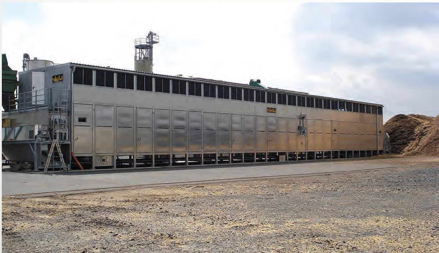
项目地：Ziegler, 德国 | 型号：BT 1/6200-40.5 | 安装年份：2007 干燥物料：木屑 | 出料能力：约13.5吨/小时 | 降水区间：50% - 10%湿度
