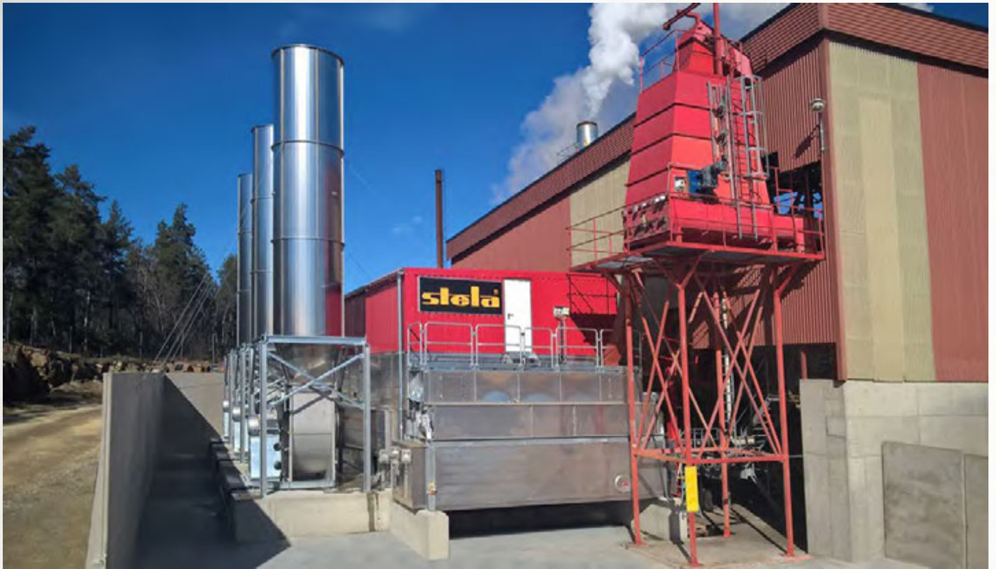
项目地：Agroenergi Neova Pellets AB, 瑞典 | 型号：BT 1/6200-22.5 | 安装年份：2017 干燥物料：木屑 | 出料能力：约7.5吨/小时 | 降水区间：37.3% - 8%湿度
