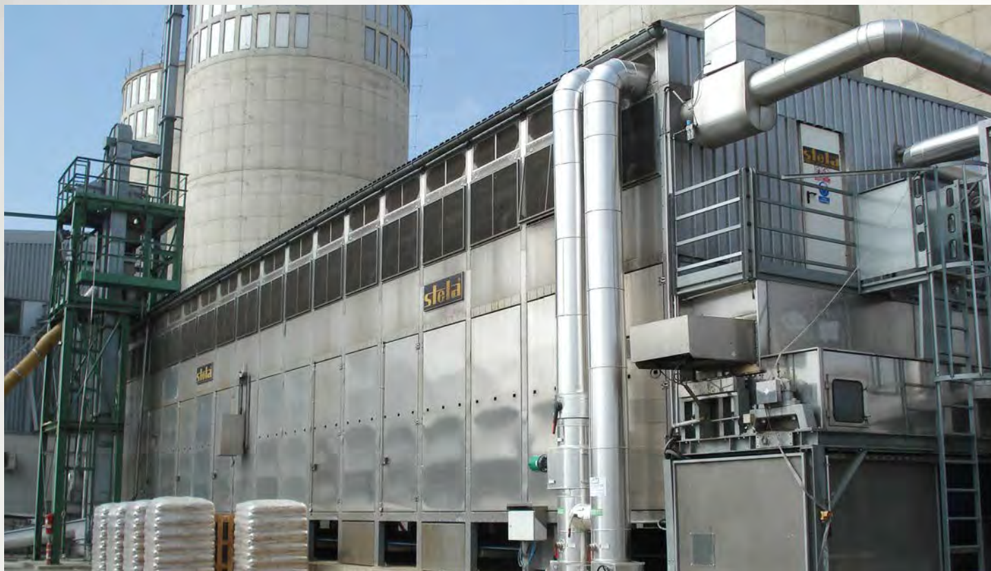
项目地: Mayr-Melnhof, 捷克 | 型号: BT 1/6200-28.5 | 安装年份: 2012 干燥物料: 木屑 | 出料能力: 约10.0吨/小时 | 降水区间: 50% - 10%湿度
