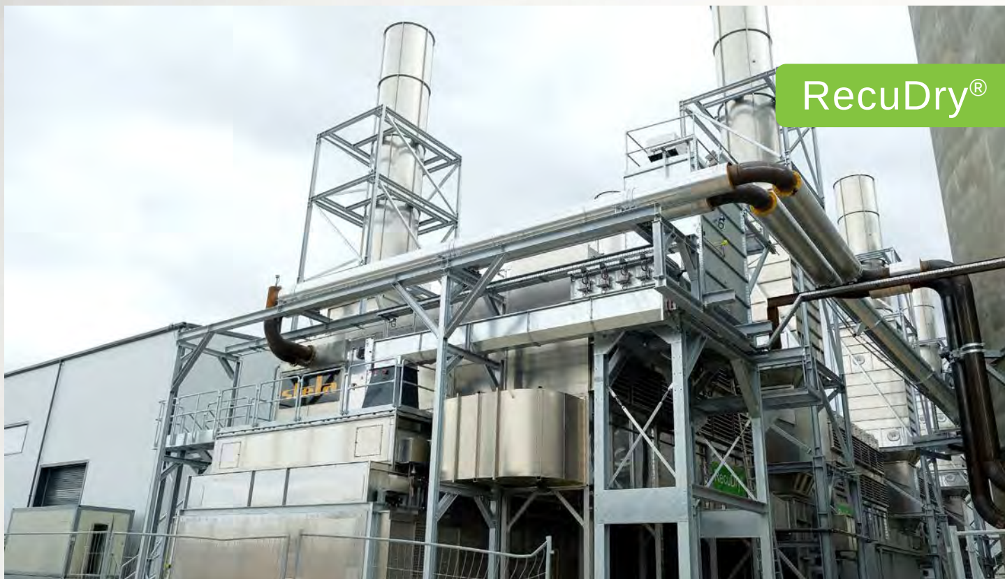
项目地：HS Timber, 德国 | 型号：BTU RecuDry 1/6200-54 | 安装年份：2021 干燥物料：木屑 | 出料能力：约15.4吨/小时 | 降水区间：51% - 10%湿度
