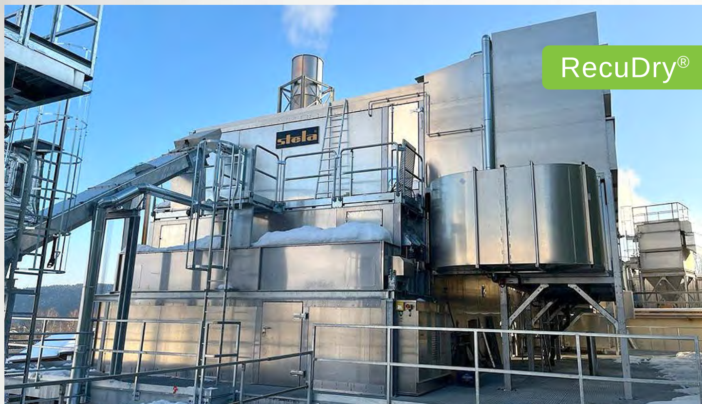
项目地：Bayerwald Pellet, 德国 | 型号：BTU RecuDry 1/6200-19.5 | 安装年份：2023 干燥物料：湿木屑、湿刨花 | 出料能力：约4.5吨/小时 | 降水区间：50% - 10%湿度
