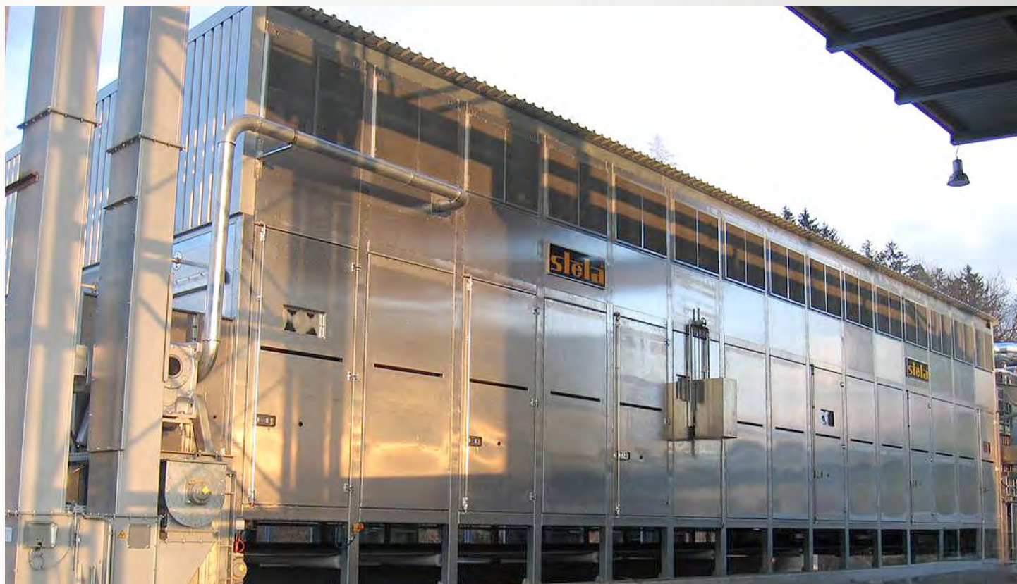
项目地: Hasslacher, 奥地利 | 型号: BT 1/6200-22.5 | 安装年份: 2007 干燥物料: 木屑 | 出料能力: 约8.5吨/小时 | 降水区间: 50% - 10%湿度
