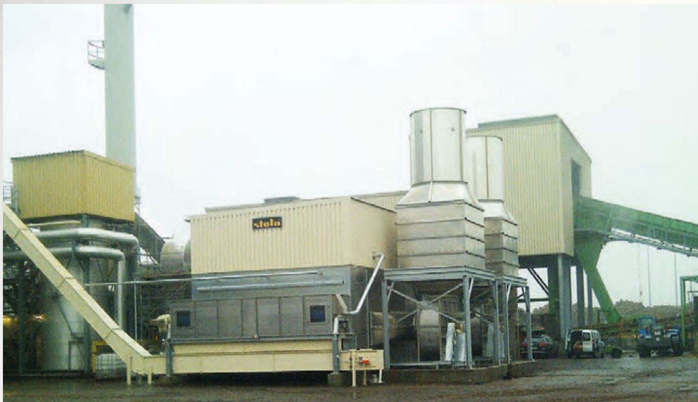
项目地：SWISS KRONO TEX GmbH & Co. KG, 德国 | 型号：BT 1/6200-13.5 | 安装年份：2013 干燥物料：木片、树皮 | 出料能力：约4.7吨/小时 | 降水区间：50% - 25%湿度
