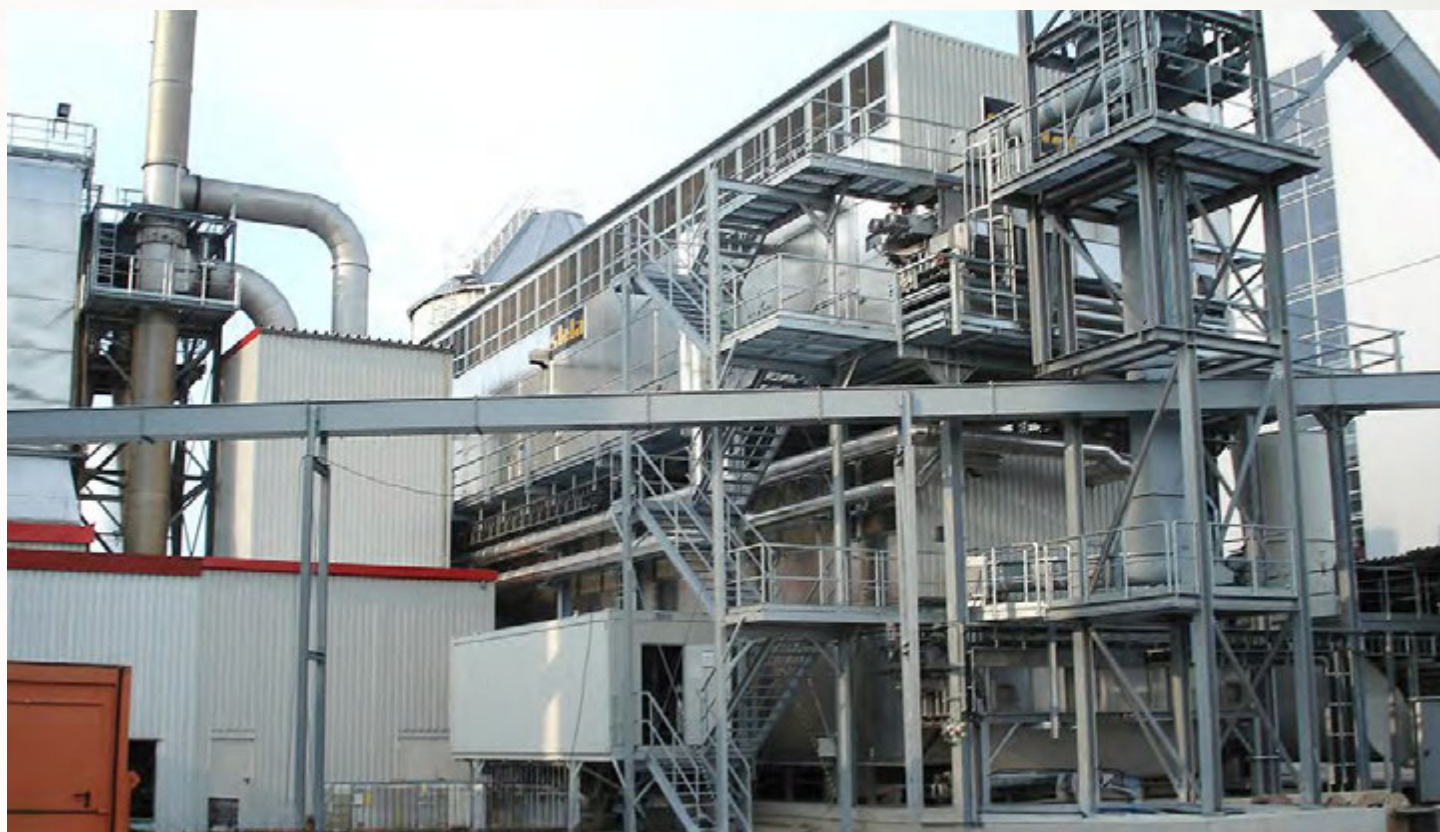
项目地：Pfeifer Holz GmbH, 德国 | 型号：2x BT 1/6200-33 | 安装年份：2007 干燥物料：木屑 | 出料能力：约30.0吨/小时 | 降水区间：42% - 3%湿度
