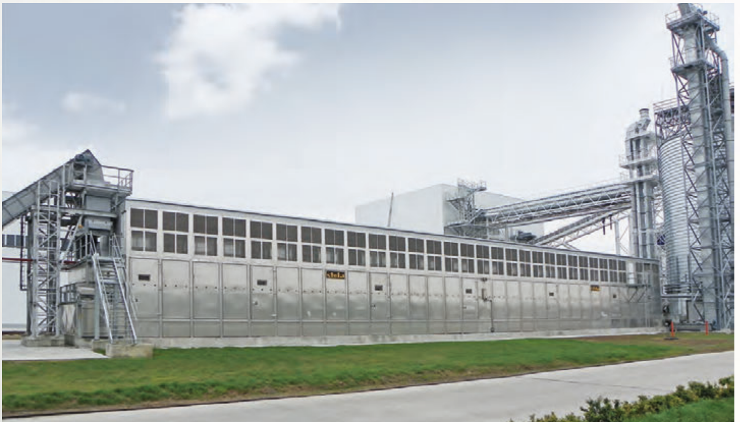
项目地：BF Project Limited, 乌克兰 | 型号：BT 1/6200-48 | 安装年份：2016 干燥物料：木屑 | 出料能力：约22.0吨/小时 | 降水区间：45% - 10%湿度
