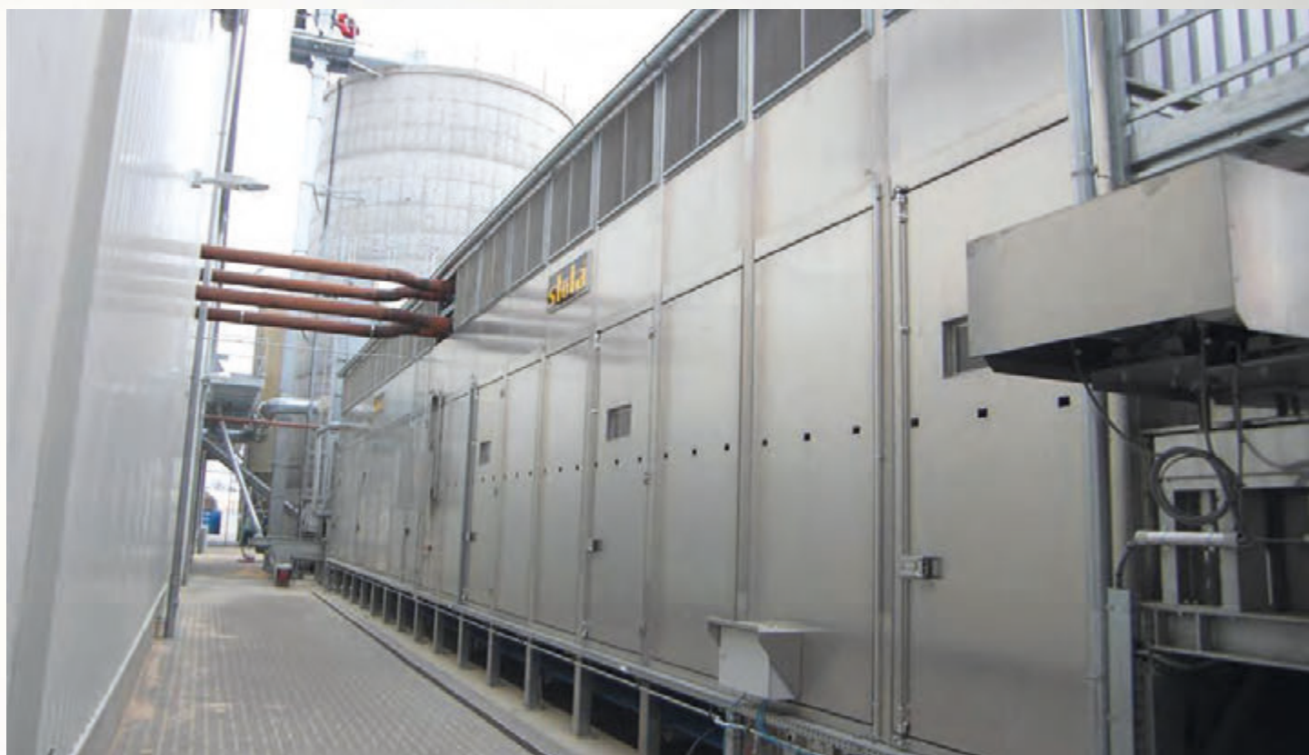
项目地：BEN BioEnergie, 德国 | 型号：BT 1/6200-25.5 | 安装年份：2008 干燥物料：木屑 | 出料能力：约8.0吨/小时 | 降水区间：48% - 8%湿度
