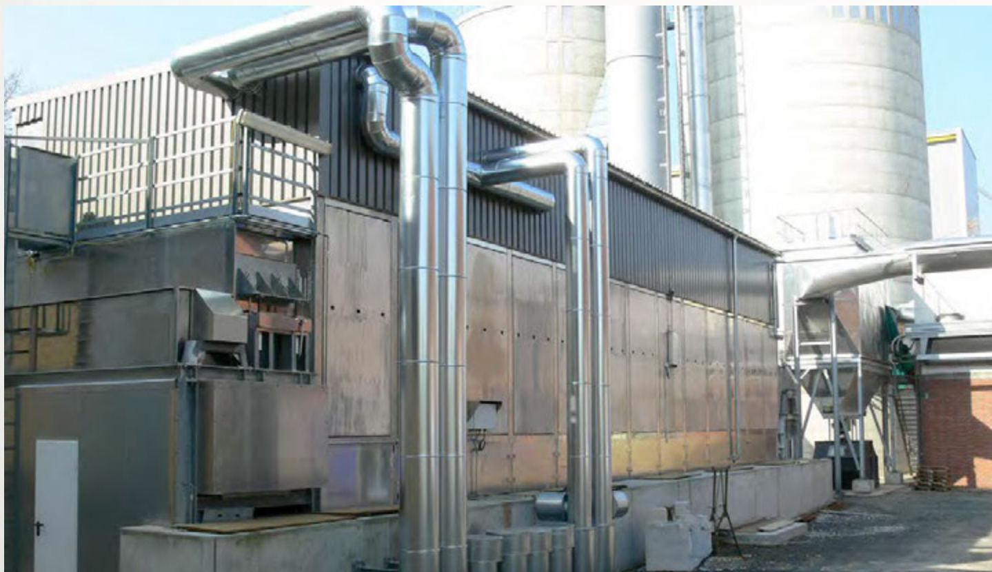
项目地：EVO Energieversorgung, 德国 | 型号：BT 1/6200-19.5 | 安装年份：2010 干燥物料：木屑 | 出料能力：约6.0吨/小时 | 降水区间：50% - 9%湿度
