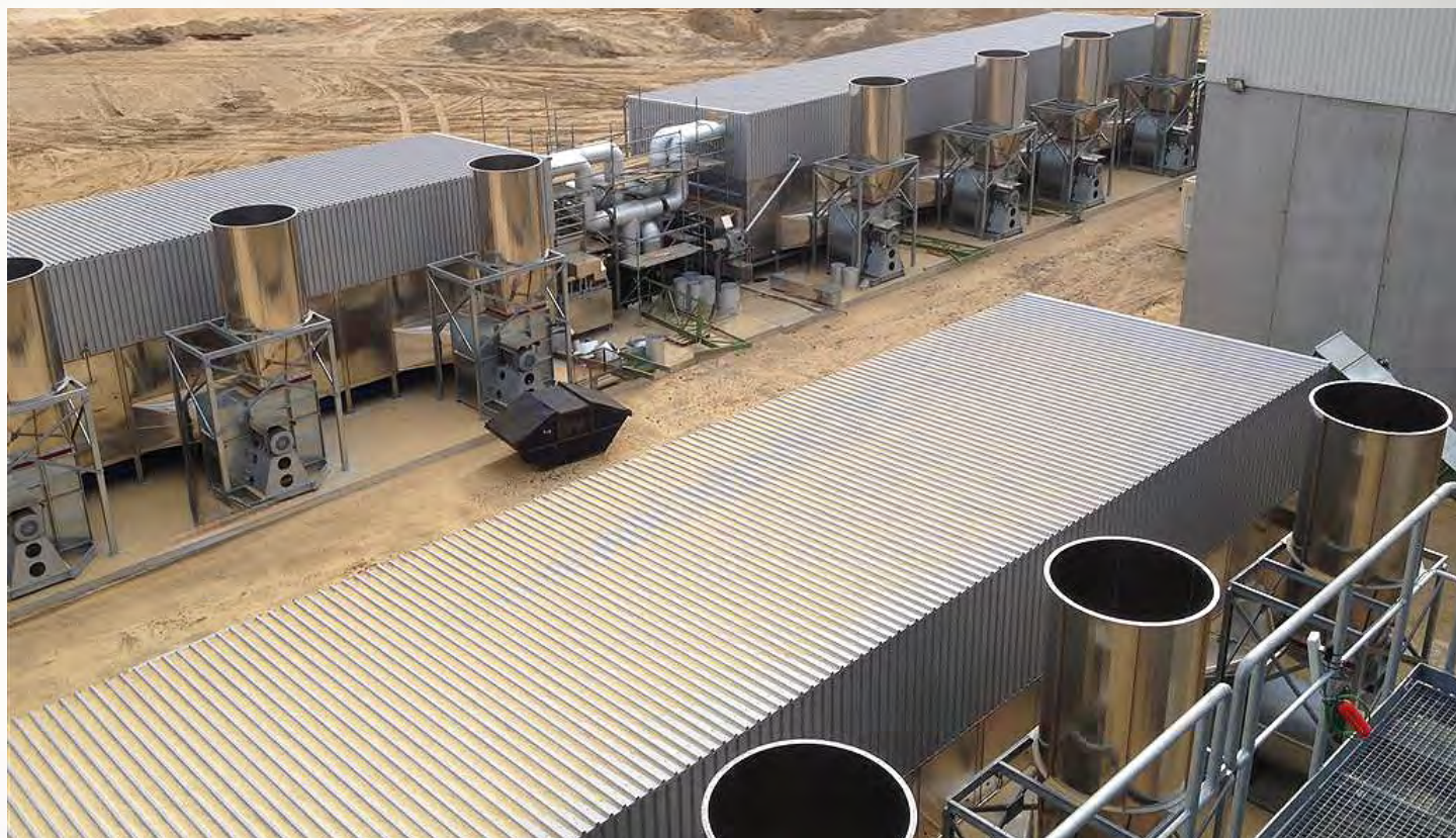
项目地：HIT Holzindustrie, 德国 | 型号：3x BT 1/6200-28.5 | 安装年份：2013 干燥物料：木屑 | 出料能力：约3x 7.5吨/小时 | 降水区间：50% - 3%湿度
