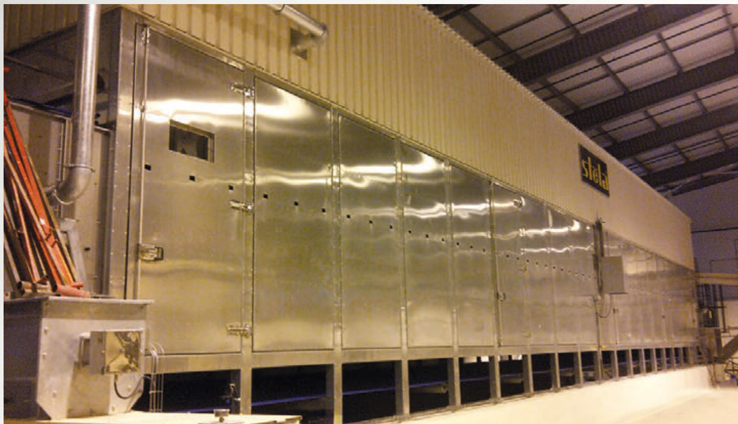
项目地：Münch Edelstahl, 俄罗斯 | 型号：BT 1/6200-28.5 | 安装年份：2015 干燥物料：木屑 | 出料能力：约9.5吨/小时 | 降水区间：55% -10%湿度
