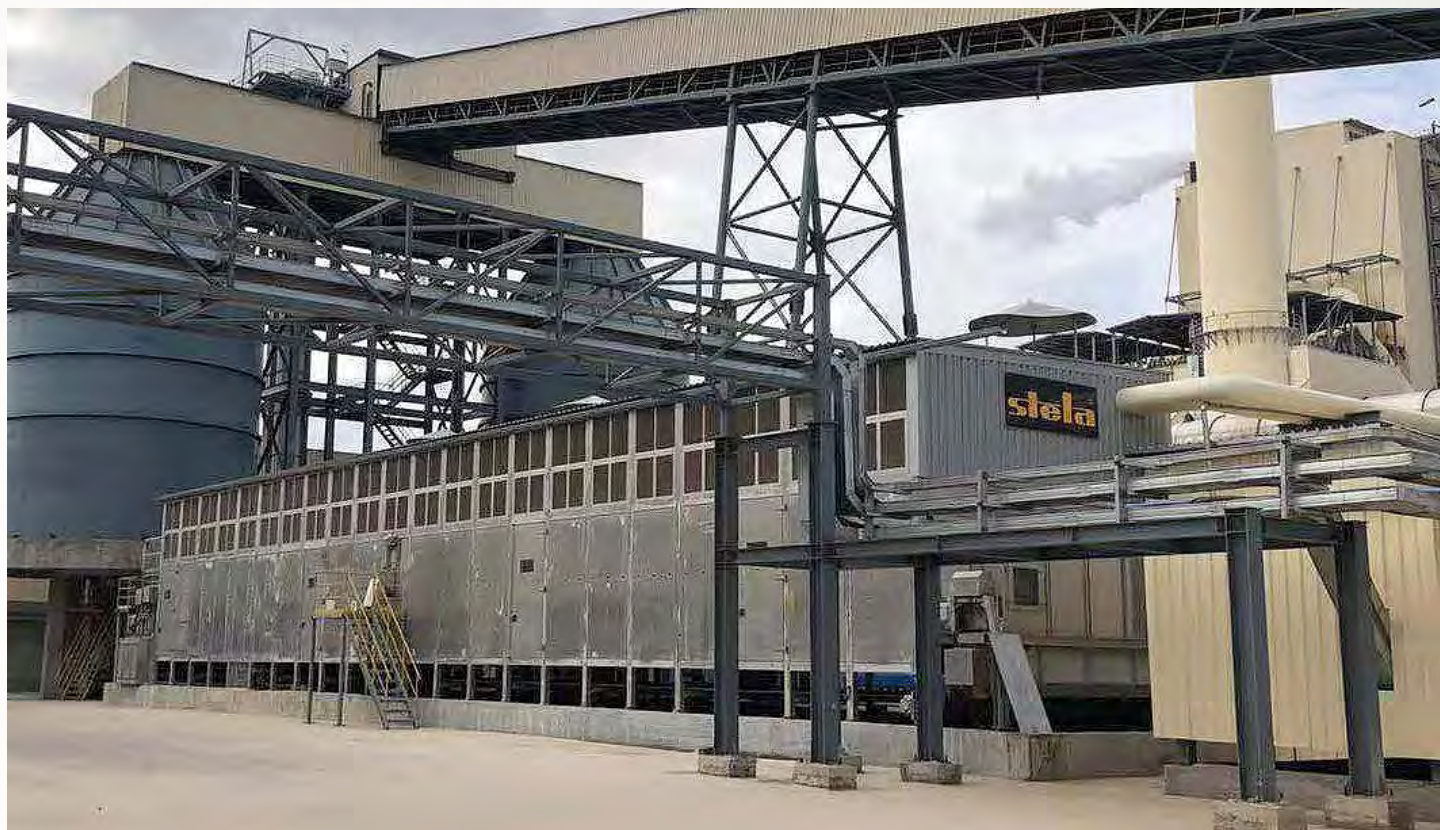
项目地：太阳纸业, 老挝 | 型号：2x BT 1/6200-33 | 安装年份：2019 干燥物料：纸污泥、木屑树皮和浆渣 | 出料能力：约2x 40.2吨/小时 | 降水区间：55% - 30%湿度
