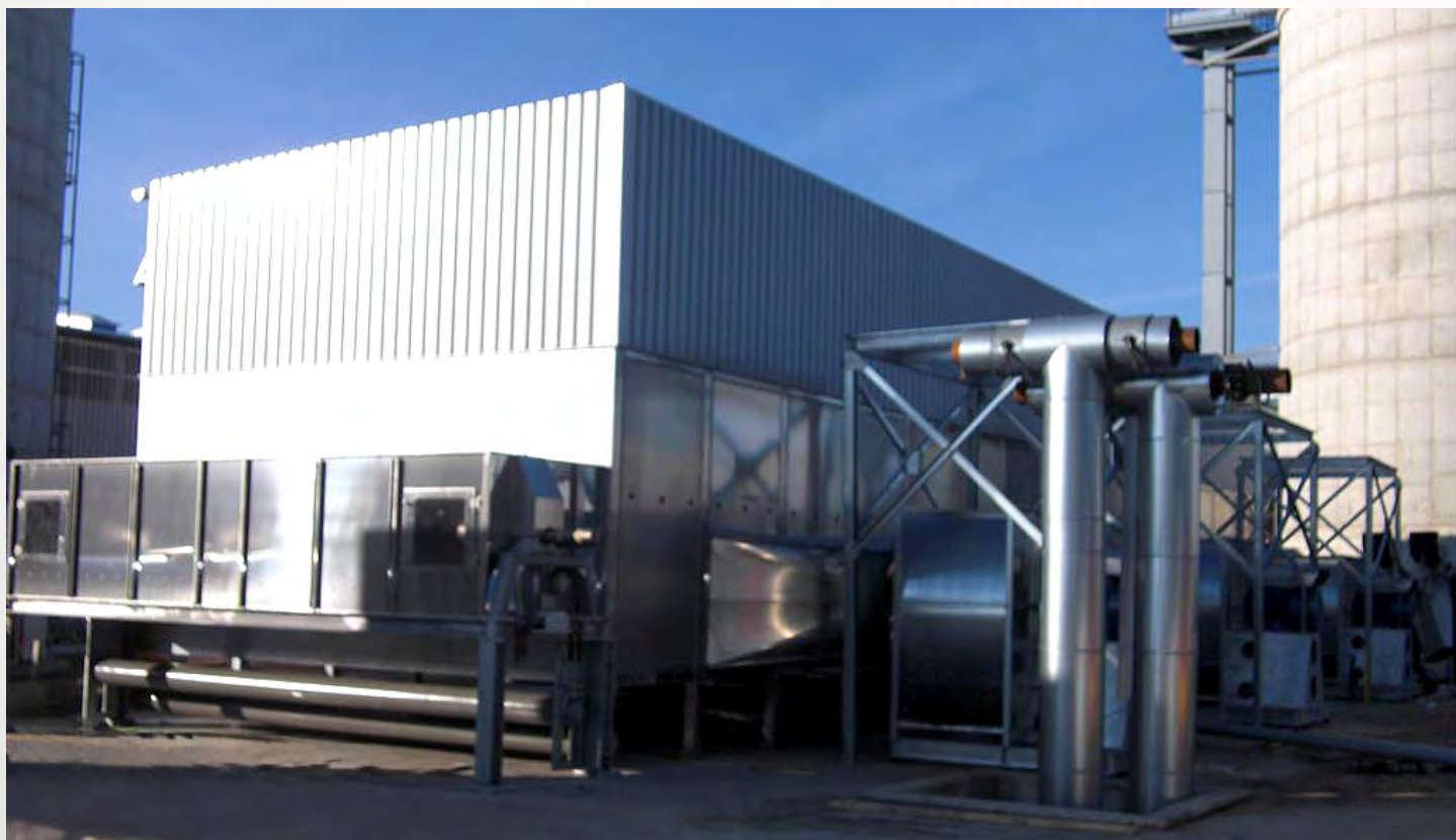
项目地：EKO Energy GmbH, 德国 | 型号：2x BT 1/6200-22.5 | 安装年份：2011 干燥物料：木屑 | 出料能力：约2x 7.5吨/小时 | 降水区间：50% - 10%湿度
