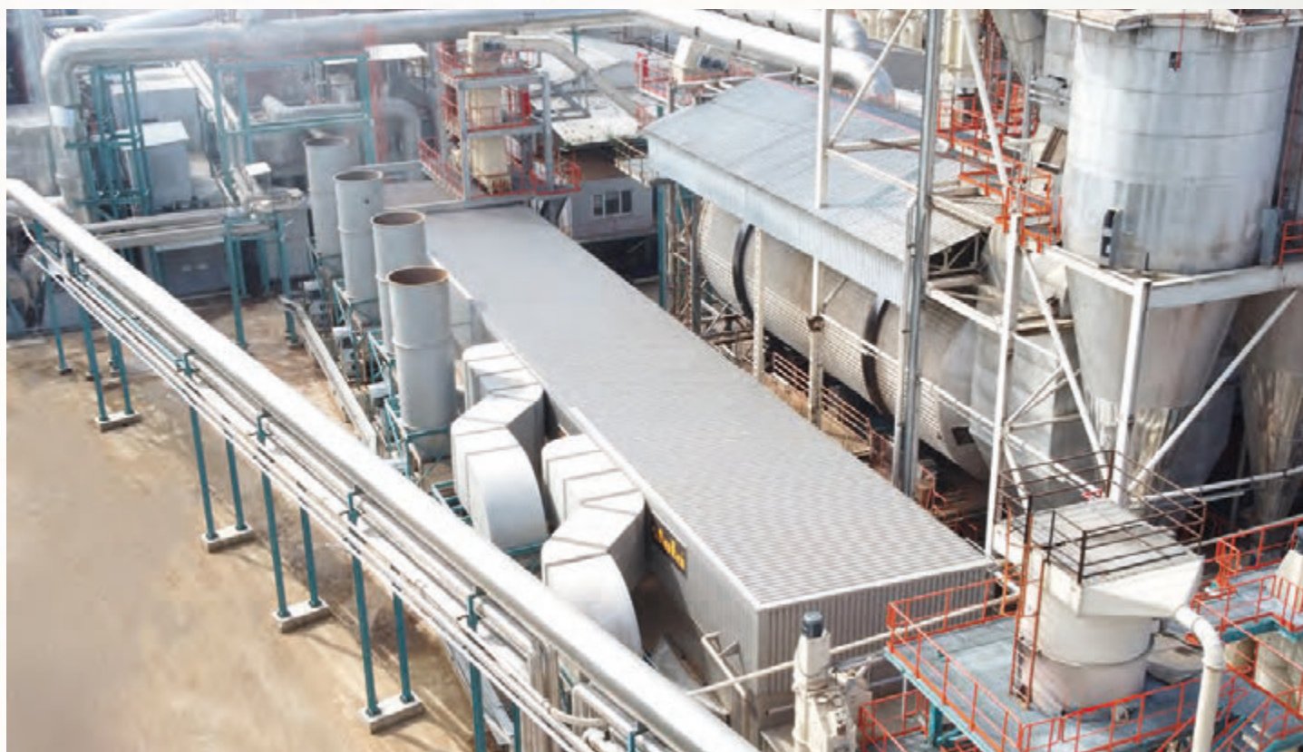
项目地：Kastamonu Samsun, 土耳其 | 型号：BTU 1/6200-45 | 安装年份：2021 干燥物料：木屑、木片 | 出料能力：约27.3吨/小时 | 降水区间：82% - 1.5%含水率
