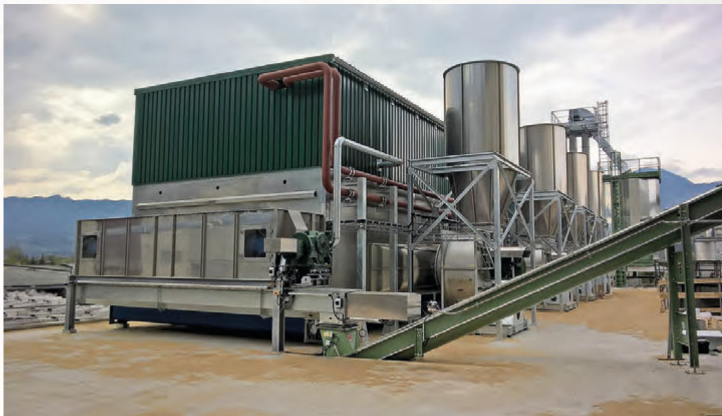
项目地：Pfeifer Holz GmbH & Co. KG, 奥地利 | 型号：BT 1/6200-27 | 安装年份：2017 干燥物料：木屑、湿磨料 | 出料能力：约5.0吨/小时 | 降水区间：54% - 10%湿度
