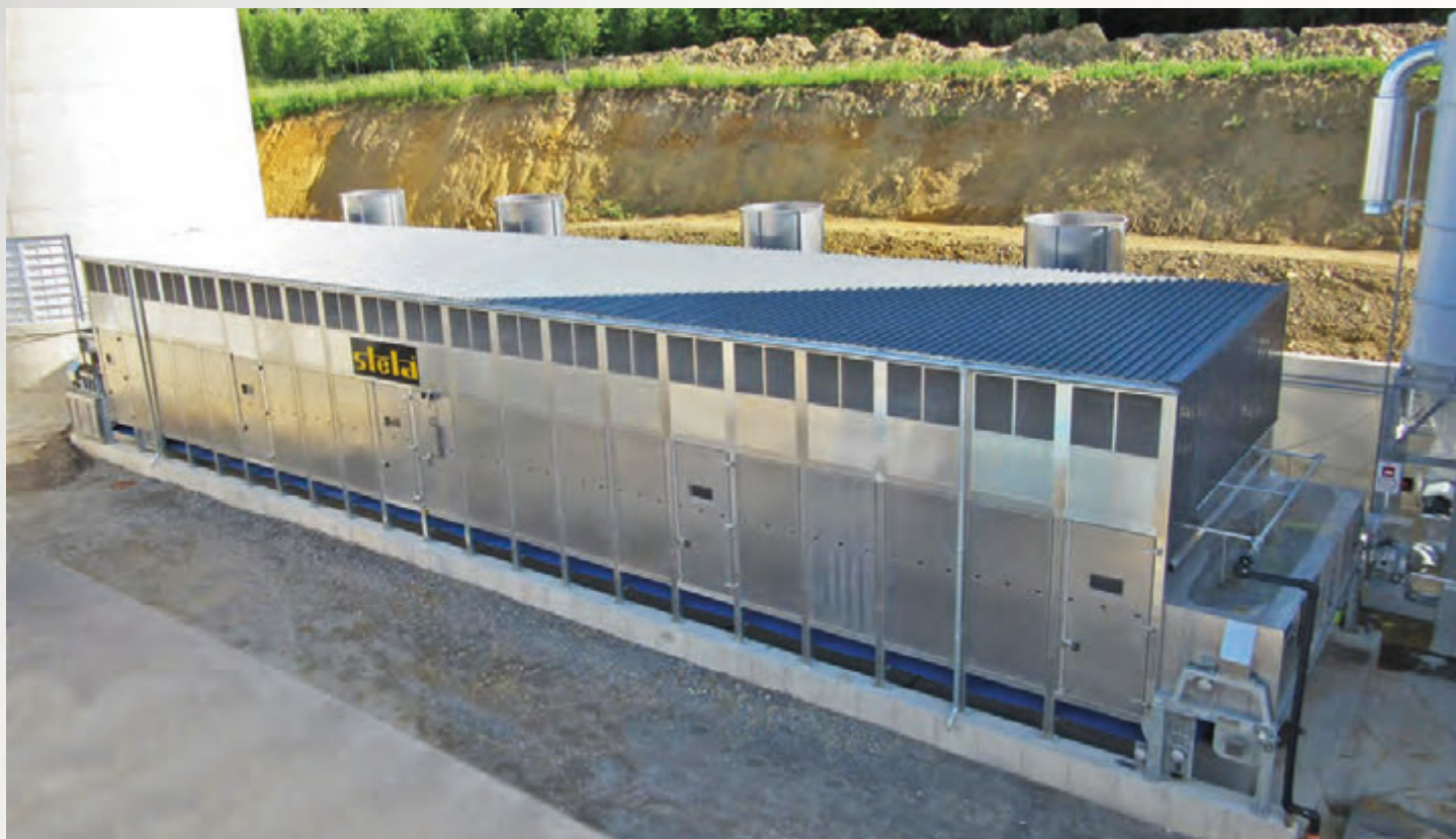
项目地：Stora Enso Wood Products, 捷克 | 型号：BT 1/6200-31.5 | 安装年份：2015 干燥物料：木屑 | 出料能力：约9.0吨/小时 | 降水区间：50% - 10%湿度
