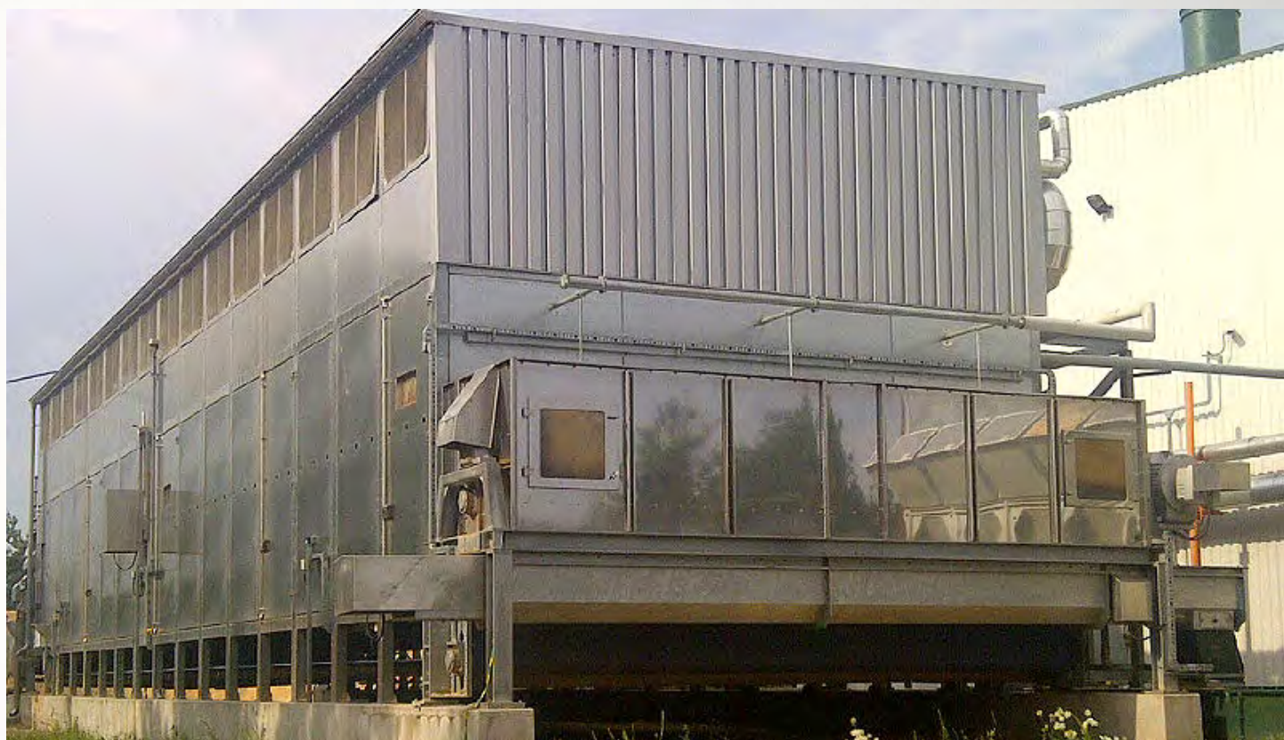
项目地: Eco Power Plant, 波兰 | 型号: BT 1/6200-24 | 安装年份: 2012 干燥物料: 木屑 | 出料能力: 约8.0吨/小时 | 降水区间: 50% - 10%湿度
