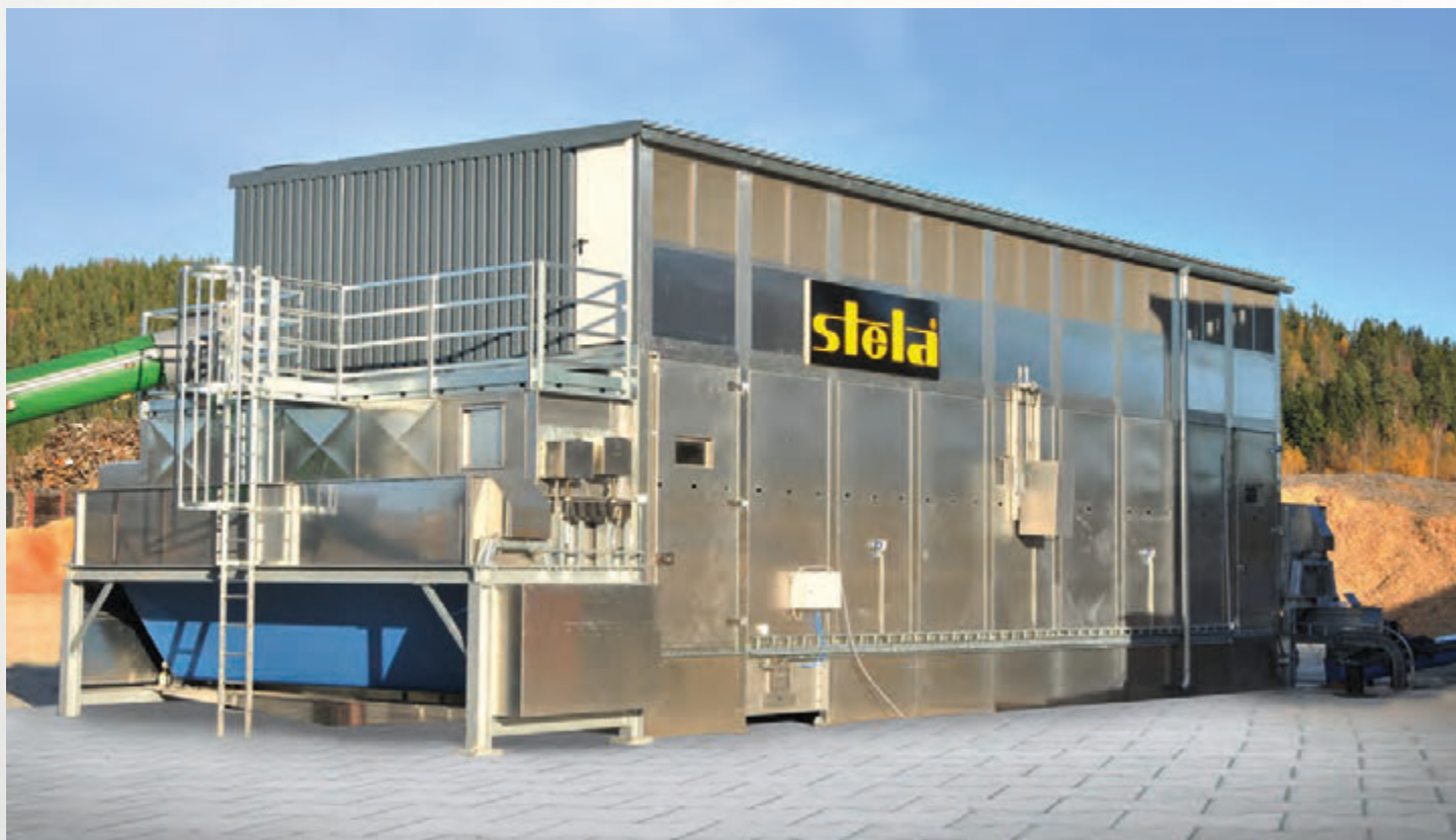
项目地：Solør Bioenergie AS, 挪威 | 型号：BT 1/6200-13.5 | 安装年份：2013 干燥物料：木片、树皮 | 出料能力：约3.7吨/小时 | 降水区间：57% - 10%湿度
