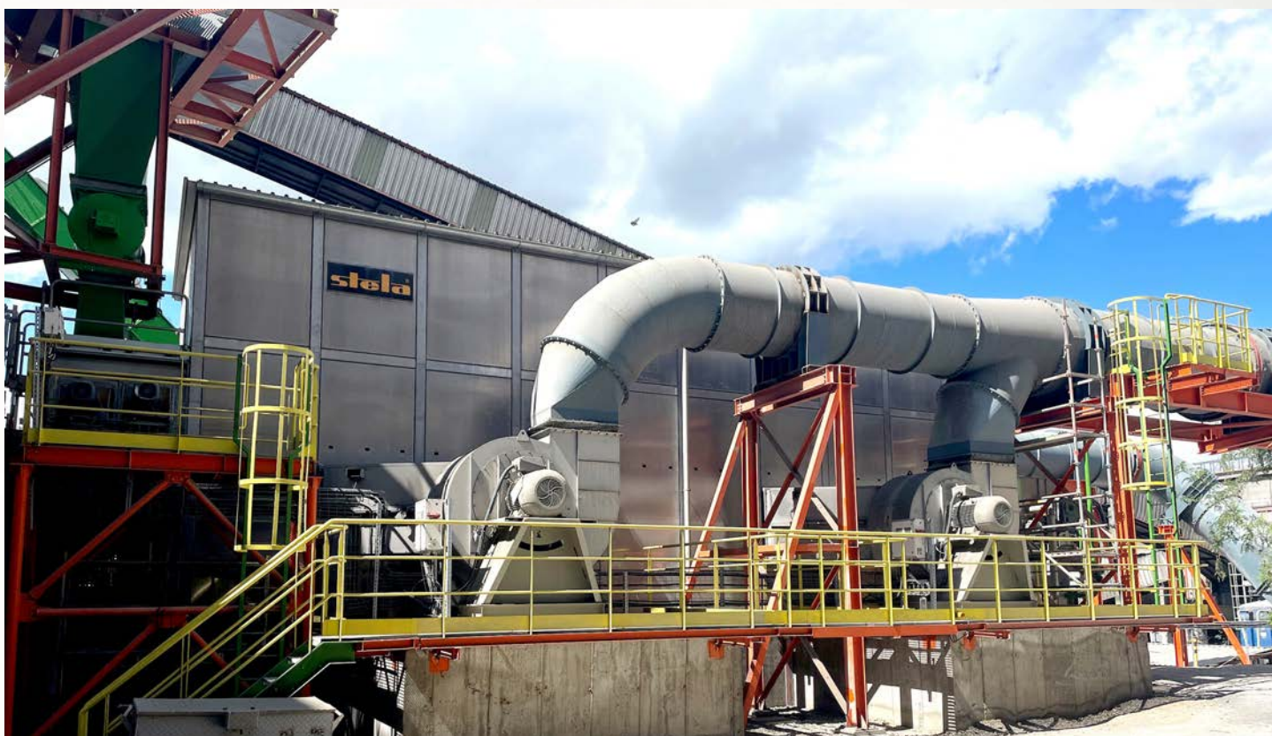
项目地：Romcim S.A., 罗马尼亚 | 型号：BT 1/6200-15 | 安装年份：2023 干燥物料：SSW固废垃圾 | 出料能力：约8.0吨/小时 | 降水区间：35% - 10%湿度
