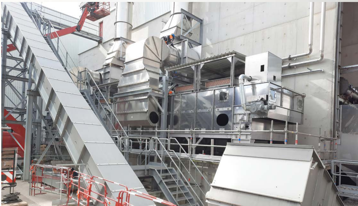
项目地：Blue Paper, 法国 | 型号：BTL 1/3000-20 | 安装年份：2023 干燥物料：Rejects垃圾燃料（塑料和纤维） | 出料能力：约3.0吨/小时 | 降水区间：45% - 8-10%湿度
