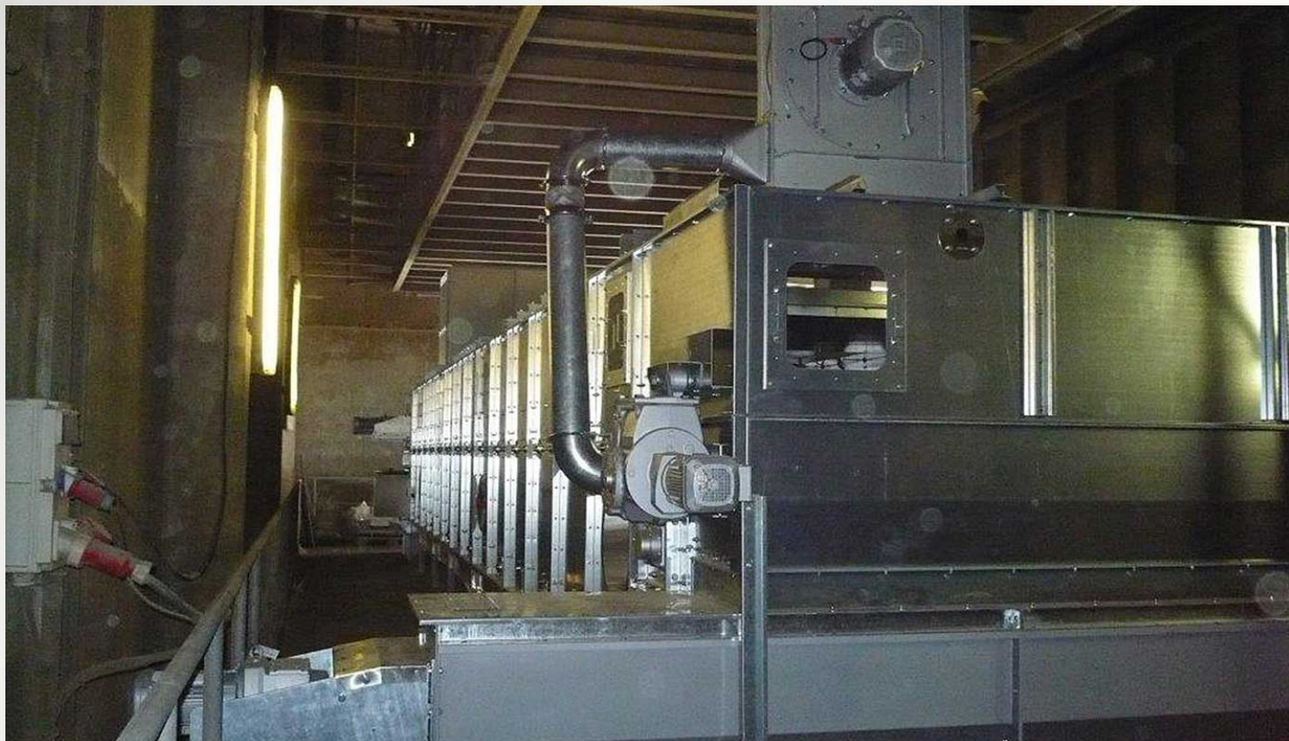
项目地：东德水泥, 德国 | 型号：BTL 1/3000-14 | 安装年份：2017 干燥物料：RDF垃圾燃料 | 蒸发量：最大1.1吨/小时
