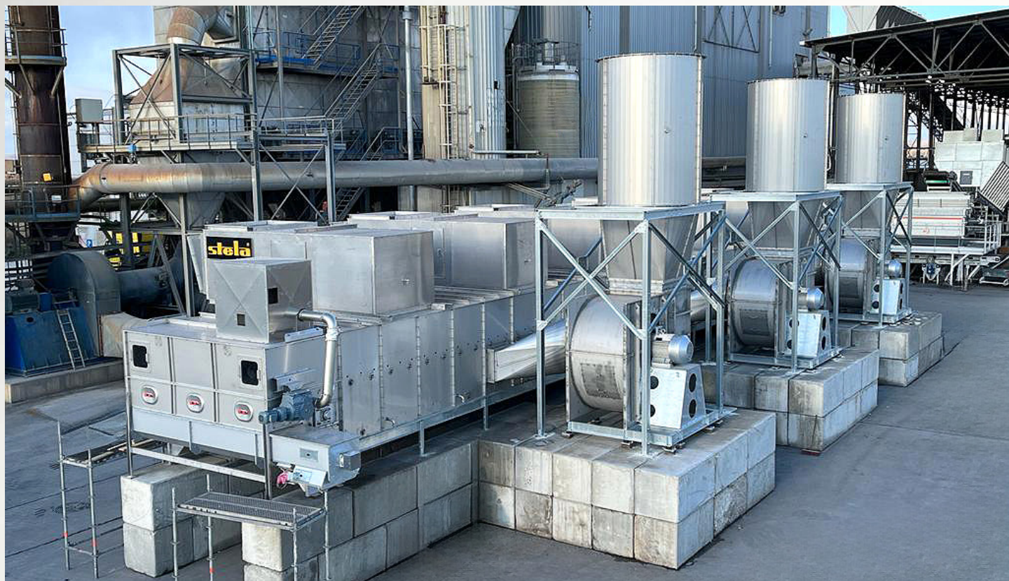
项目地: Repsan Energy SRL, 罗马尼亚 | 型号: BTL 1/3000-26 | 安装年份: 2022 干燥物料: RDF垃圾燃料和MSW城市固废 | 出料能力: 约10.8吨/小时 | 降水区间: 40% - 25%湿度
