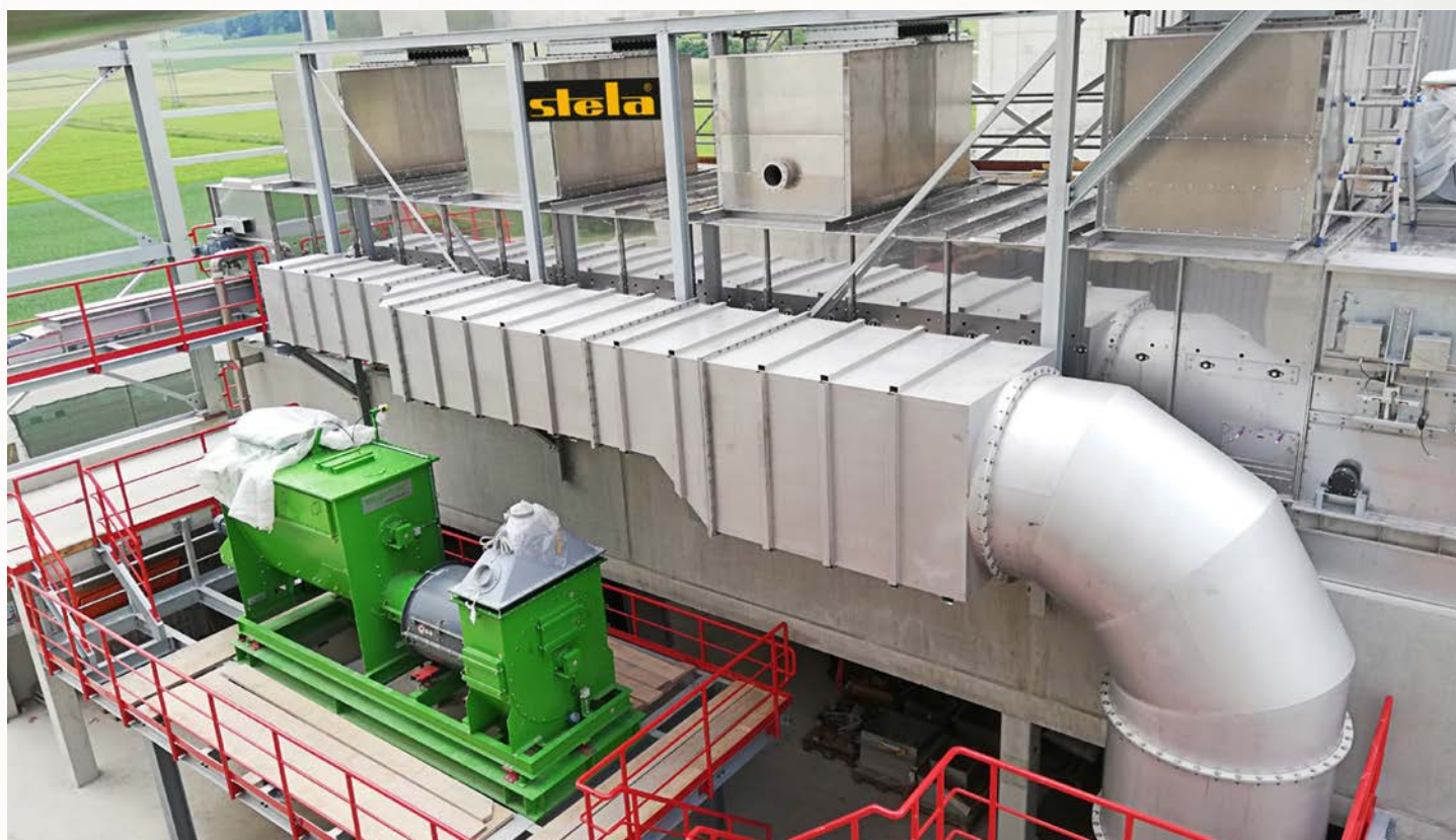
项目地：Schwenk 水泥, 德国 | 型号：BTL 1/3000-14 | 安装年份：2022 干燥物料：RDF垃圾燃料 | 出料能力：约9.0吨/小时 | 降水区间：15% - 5%湿度
