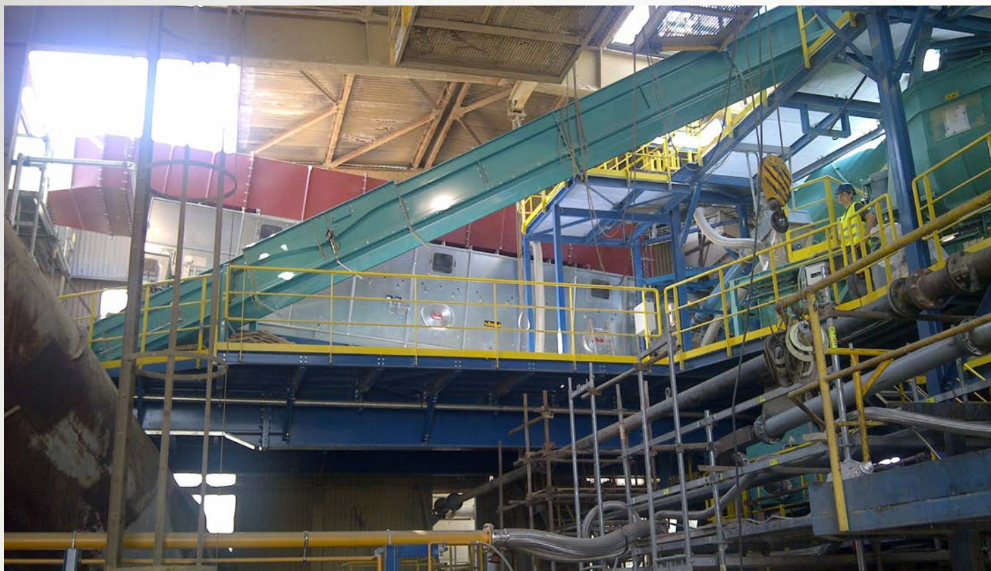
项目地：Lafarge, 捷克 | 型号：BTL 1/3000-8 | 安装年份：2014 干燥物料：SSW固废垃圾 | 出料能力：约5.7吨/小时 | 降水区间：26% - 10%湿度
