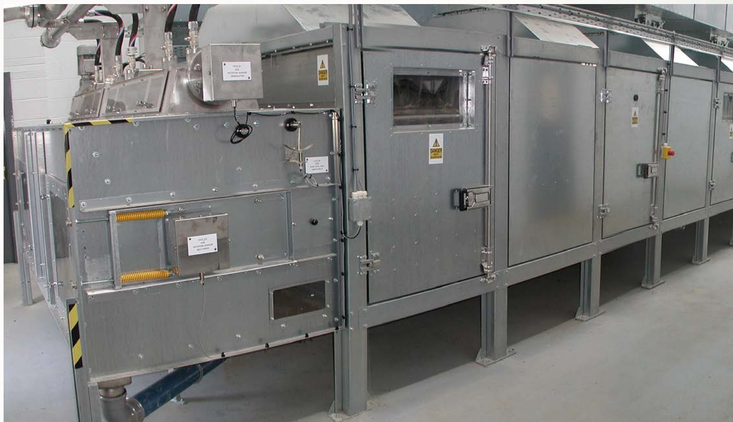
项目地：Euroby, 爱尔兰 | 型号：PBT 2/2500-17 | 安装年份：2009 干燥物料：市政污泥 | 蒸发量：1.0吨/小时
