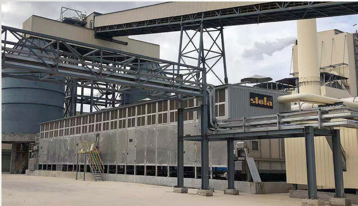
项目地：太阳纸业, 老挝 | 型号：2x BT 1/6200-33 | 安装年份：2019 干燥物料：纸污泥和浆渣 | 出料能力：约2x 40.2吨/小时 | 降水区间：55% - 30%湿度
