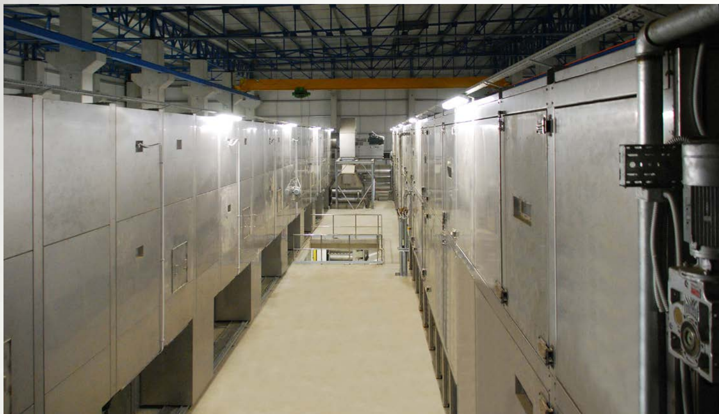
项目地: Municipality of Izmir, 土耳其 | 型号: 4x PBT 2/4000-39 | 安装年份: 2013 干燥物料: 市政污泥 | 蒸发量: 25.0吨/小时
