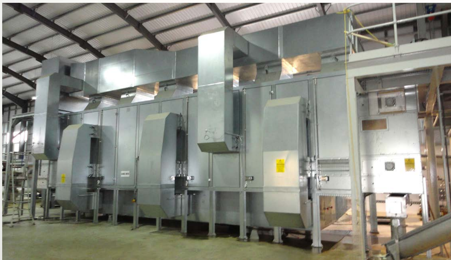
项目地: Electrical & Pump Services Ltd., 爱尔兰 | 型号: PBT 2/2500-12 | 安装年份: 2012 干燥物料: 公用市政污泥 | 蒸发量: 1.25吨/小时
