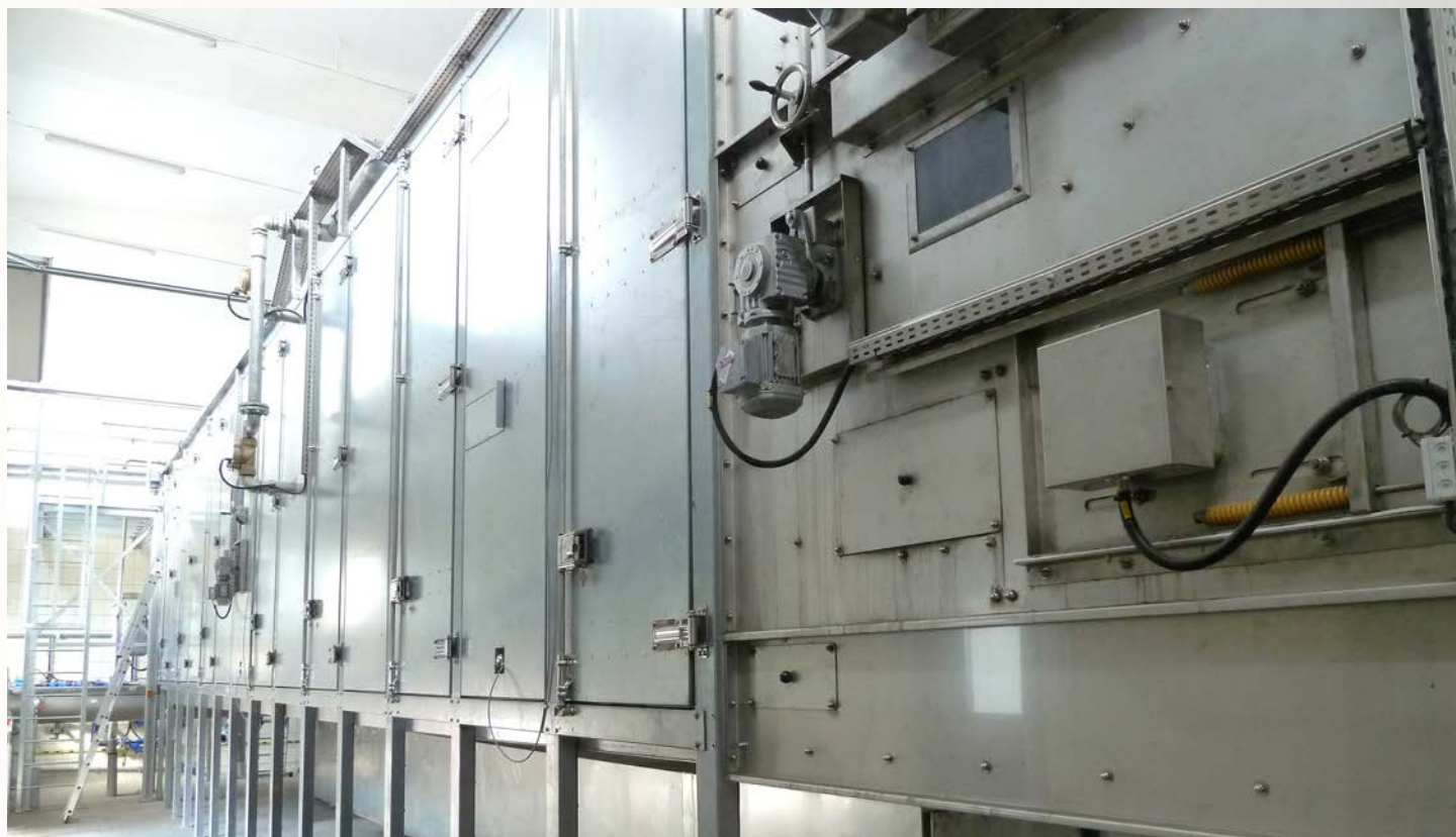
项目地：SeenTechnologie, 波兰 | 型号：PBT 2/2500-14 | 安装年份：2013 干燥物料：市政污泥 | 蒸发量：1.25吨/小时
