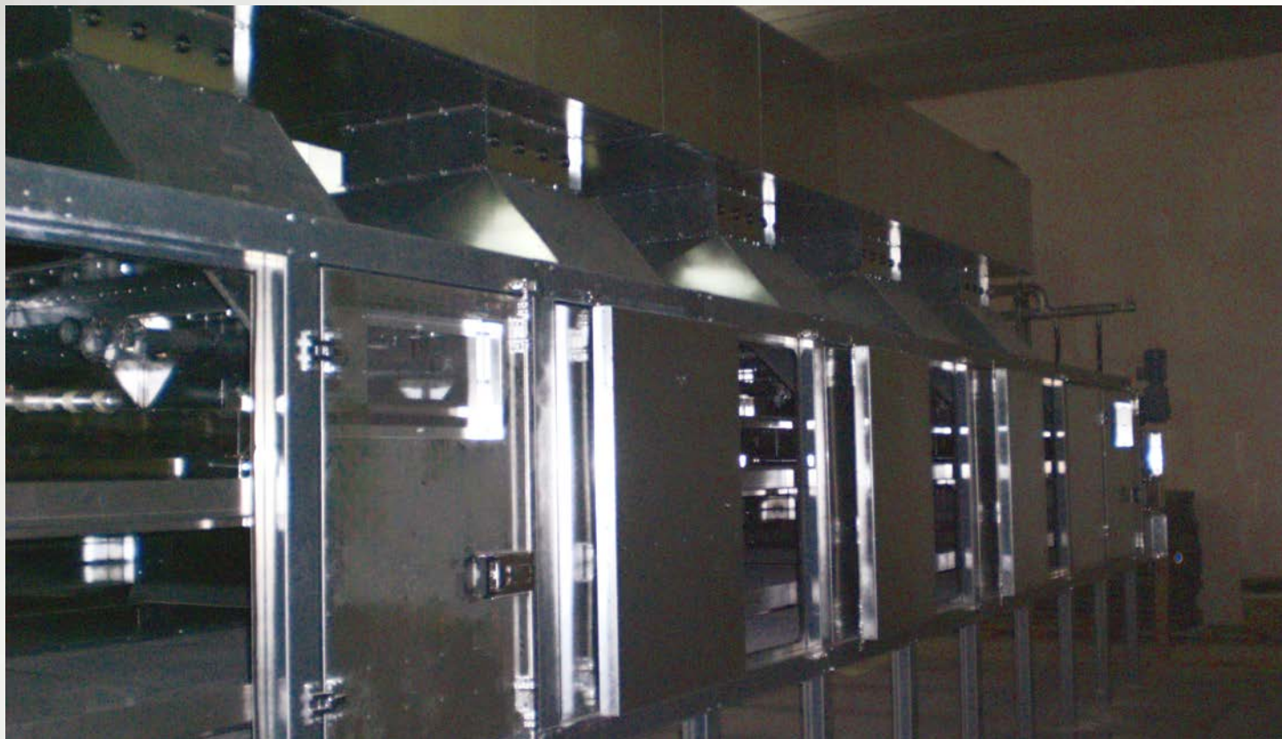
项目地: Stereau, 法国 | 型号: PBT 1/2500-15 | 安装年份: 2009 干燥物料: 市政污泥 | 蒸发量: 900公斤/小时
