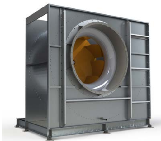
离心风机 高达160,000m³/h体积风量 静压差高达3,000 Pa
